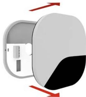
Il guscio posteriore è quello che andrà fissato alla parete utilizzando le 2 viti in dotazione. I fori **A** e **B** sono stati realizzati per rendere Xilon compatibile con le comuni scatole da incasso 503.
