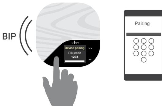
Premere per 5 secondi e poi rilasciare per entrare in modalità "Device pairing". Il dispositivo emetterà un segnale acustico, e visualizzerà a display la scritta "Device pairing" oltre al codice PIN.
